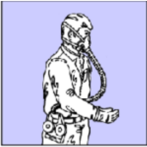
Fig. 4 - Fitrerende åndedrætsværn - Halvmaske med turboenhed (blæser) og filter i bæltet
